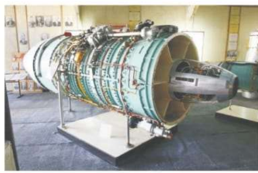
РД-3М-500 – двигатель для первого в мире турбореактивного самолета гражданского воздушного флота Ту-104.
